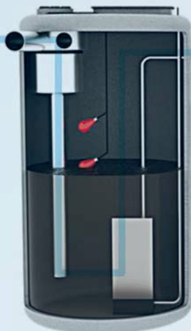
Bio-réacteur à membranes d'ultrafiltration
