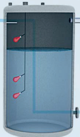
Stockage d'eau traitée
